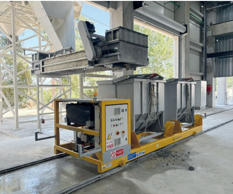
Chariot de transport pour bennes à béton alimenté par batterie
