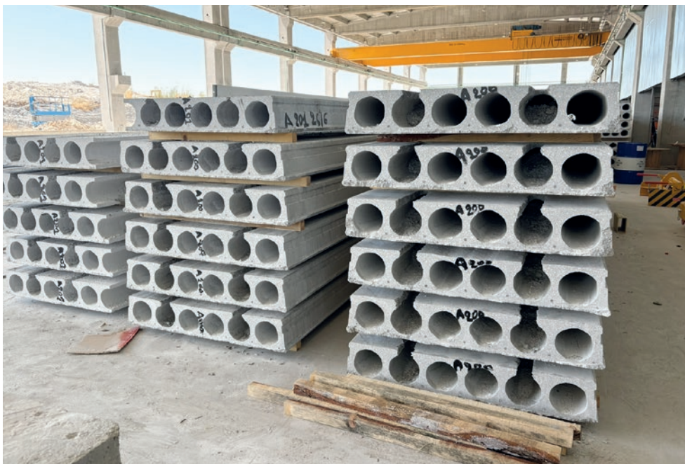
Dalles alvéolées stockées dans l'entrepôt et prêtes pour le chantier
